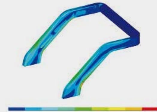
■ 后支座采用两折弯弧形后围梁与三角形斜拉梁组合设计，超强承载，可靠耐用，疲劳寿命提高30%；
